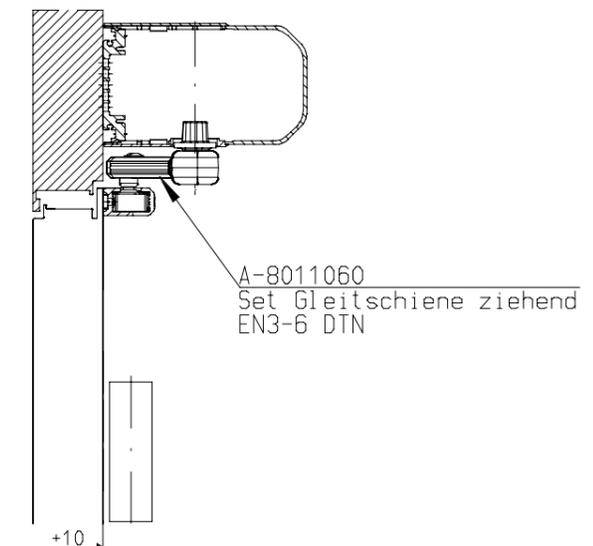
Befestigung mit M5 Schrauben oder vergleichbar.
