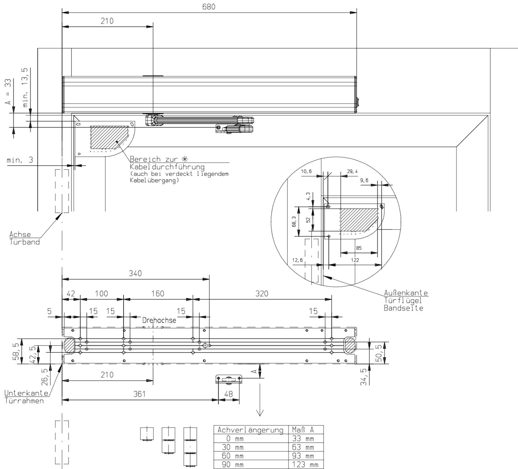
Befestigung mit M5 Schrauben oder vergleichbar.
